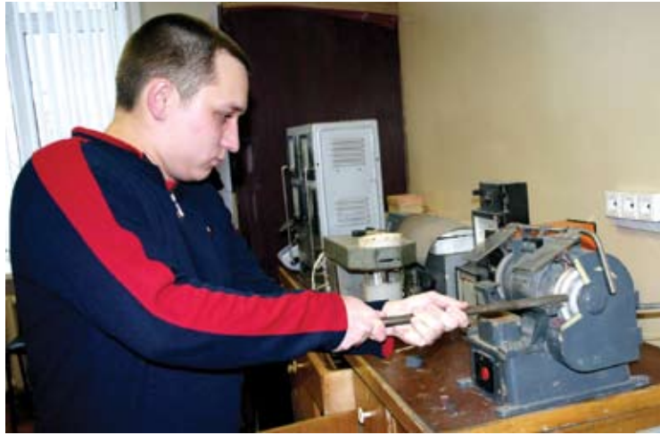
Изготовление шлифов для микроскопических исследований. Студент Е. Семенов
